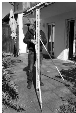
Abb. 7: Bestimmung eines Stichmaßes durch Interpolation beim Nivellement
