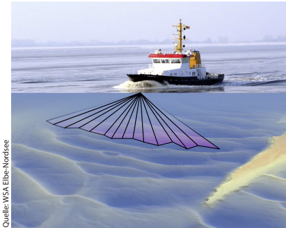
Abb. 2: Fächerecholot-Prinzip am Beispiel „Peilschiff Grimmershörn“
