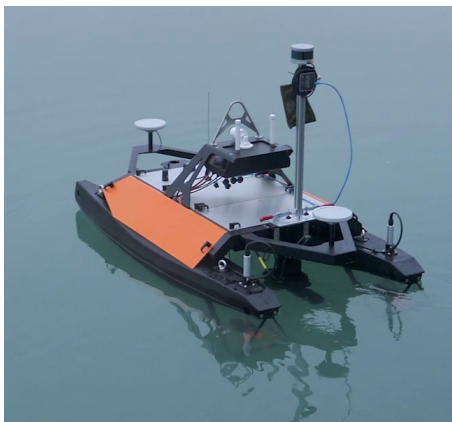
Abb. 4: Aktuelle Kartierungsplattform: Miniaturisierte Version auf Basis eines Maritime Robotics Otter (ca. 2 m × 1,1 m)
