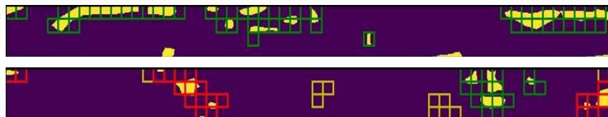
Abb. 3: Beispielhafte Ergebnisse einer Schadenserkennung zur Erkennung von Abplatzungen
