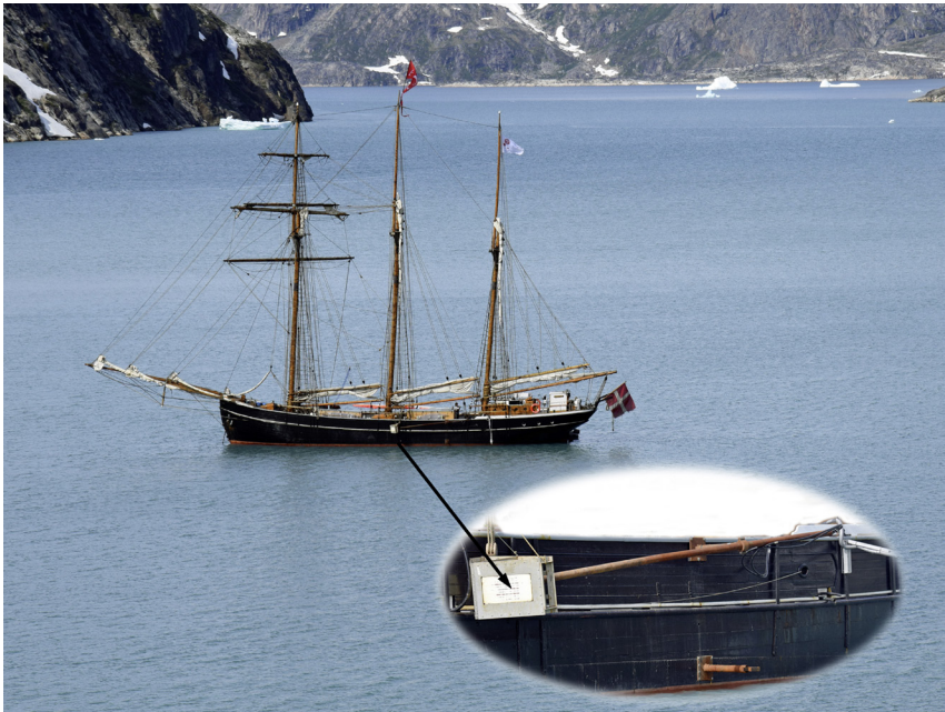
Abb. 1: Dreimast-Schoner „Activ“ im Arbeitsgebiet; der Ausschnitt zeigt die schwenkbare Schwinger-Halterung.
