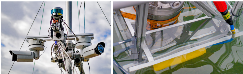
Abb. 2: Überwasser-Messsystem (links), Sonardyne INS und ITER Systems Bathyswath-2 Sonar (rechts)
