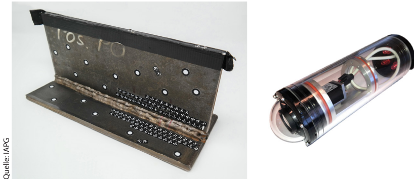
Abb. 5: Schweißnaht (links) und Prototyp des Einkamerasystems bestehend aus einem Acrylgehäuse mit Dome Port und einer Industriekamera (rechts)
