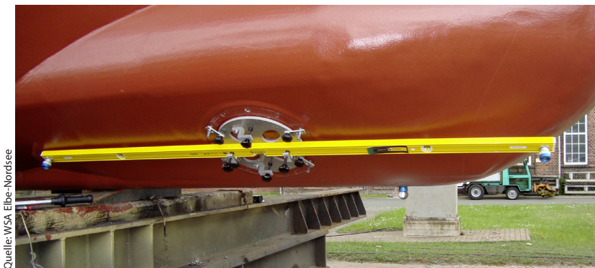
Abb. 8: Einmessung Fächerecholot Uwe Jens Lornsen
