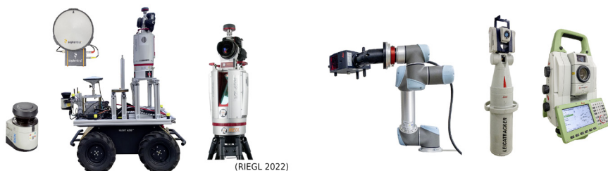
Abb. 4: Eine Auswahl der vorhandenen ROS-fähigen Systeme an der TU Wien, unter anderem von SICK, Clearpath, Universal Robot, RIEGL, Septentrio, Hexagon und Leica
