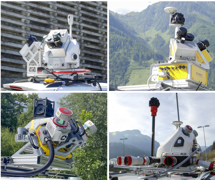
Abb. 3: Übersicht der eingesetzten, mobilen Laserscanning-Systeme: Leica Pegasus: Two Ultimate Dualhead (links oben), Siteco Road Scanner 4 (rechts oben), Trimble MX9 (links unten) und Riegl VMX-2HA (rechts unten)
