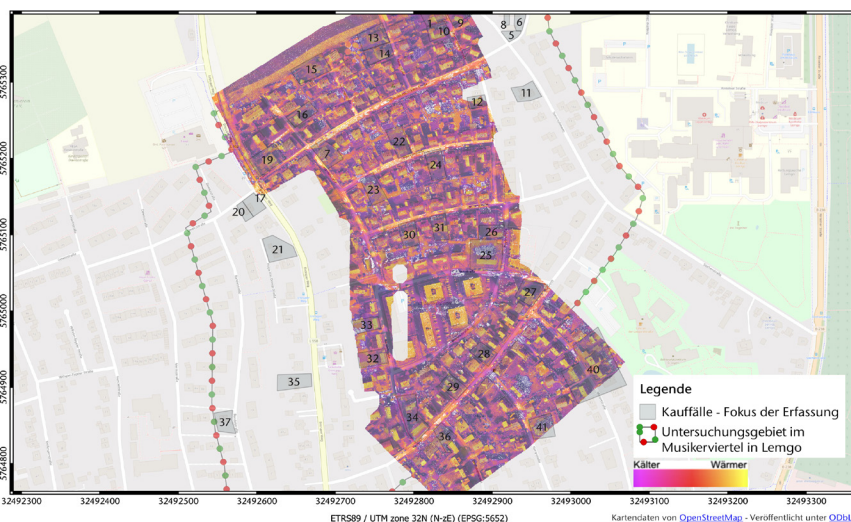
Abb. 5: Wärmeverteilung im Quartier. Hierbei stehen die magenta eingefärbten Bereich für kältere Temperaturen, wohingegen die über rot nach gelb eingefärbten Bereiche für wärmere Temperaturen stehen. Aus dieser thermischen Aufnahme lassen sich erste flächenhafte Erkenntnisse sowohl über individuelle Gebäude als auch über das Quartier als solches ableiten.
