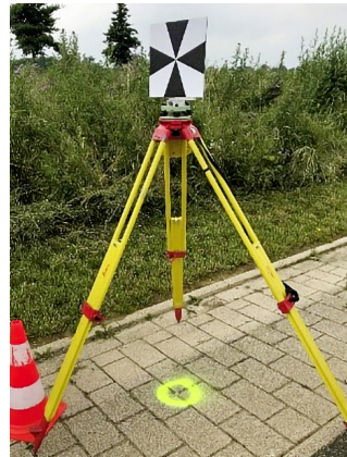
Abb. 6: Zielzeichen über Bodenpunkt
