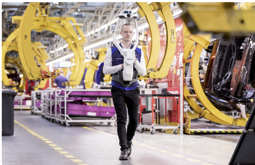
Abb. 1: Das tragbare Mobile-Mapping-System NavVis VLX im Einsatz
