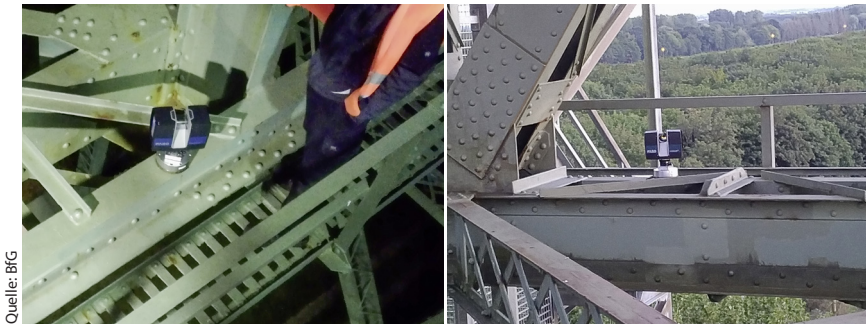
Abb. 3: Scanner auf Magnetfuß während Punktaufnahme
