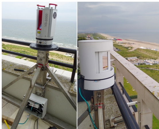
Abb. 3: RIEGL VZ-2000 Laserscanner befestigt mit Hilfe eines Metallfußes auf dem Balkon des Grand Hotel Huis der Duin ohne (links) und mit (rechts) Schutzgehäuse
