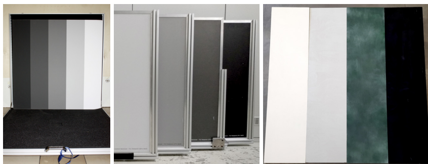
Abb. 3: Verwendete Probekörper: Links: Spectralon, Mitte: bedruckte Alucoreplatten, rechts: lackierte Multiplexplatten
