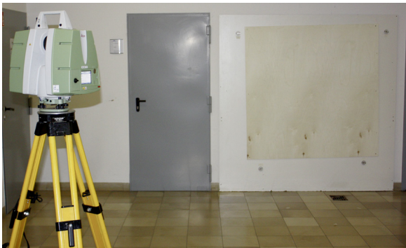
Abb. 6: Aufnahmesituation beim Scanning der unbehandelten Holztafel, die auf einem weißen Brett verschraubt ist.
