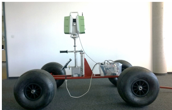
Abb. 10: Mobile-Mapping-Plattform mit Leica ProScan
