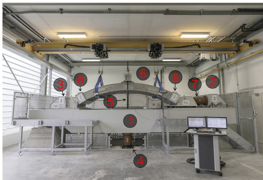
Abb. 2: Tübbingprüfstand der Montanuniversität Leoben, Lehrstuhl für Subsurface Engineering
