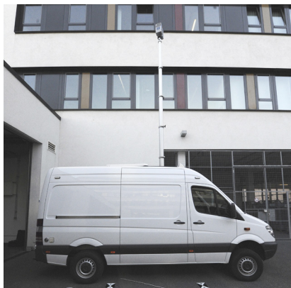
Abb. 3: Scanner auf Mast
