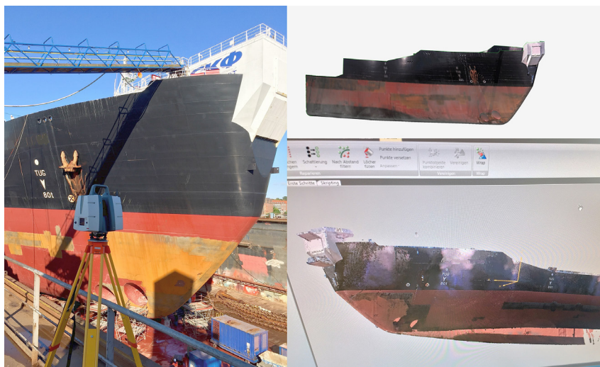
Abb. 4: Aufnahme, Punktwolke und NURBS-Oberfläche
