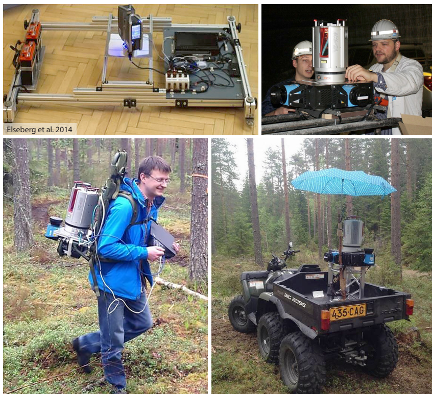
Abb. 1: Links oben: Ein drehender FARO-Scanner für Produktionsanlagen. Rechts oben: MiM3D-X1-System von Measurement in Motion im Test unter Tage. Links unten: Rucksack-basiertes mobiles Scannen. Rechts unten: Geländefahrzeug FGI/Finnland
