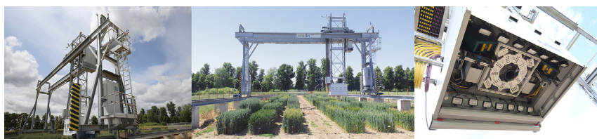
Abb. 3: Links und Mitte: Fotos der 100 m × 10 m Anlage in Rothamstadt UK. Zu sehen ist das Kransystem mit Sensorbox und die Feldaufteilung in Miniplots. Rechts: Sensorbox mit verschiedenen Sensoren, wie z.B. Laserscanner, RGB Kamera, Fluoreszenzkamera, IR Kamera und anderen Sensoren
