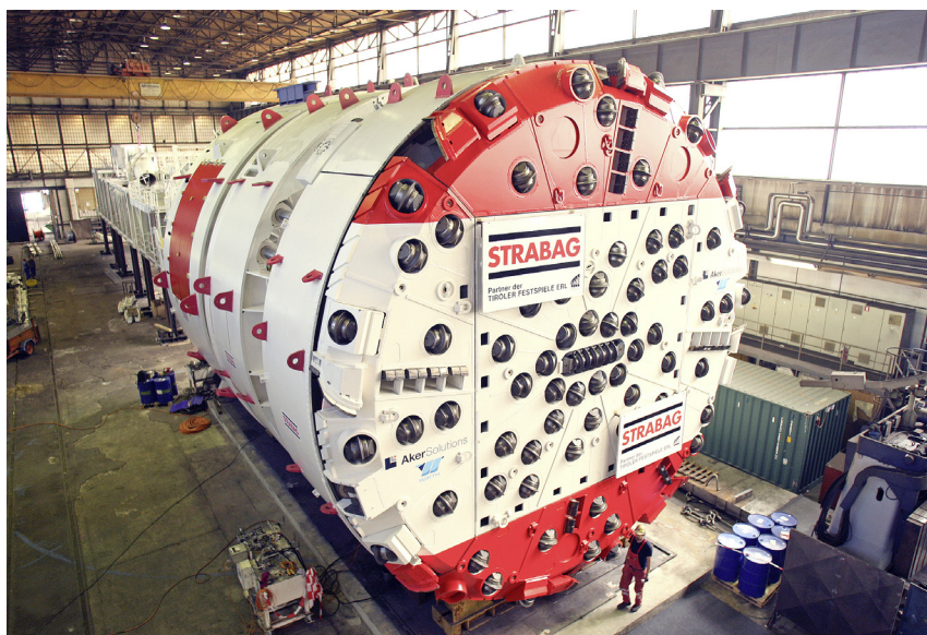
Abb. 1: Moderne Doppelschild-Tunnelvortriebsmaschine Aker-Wirth
