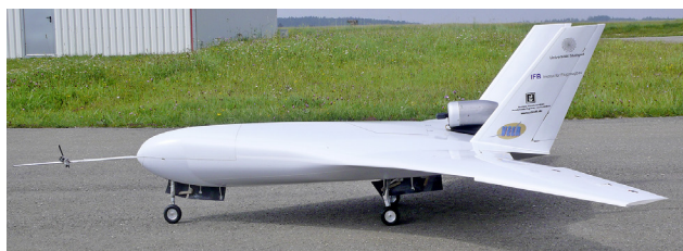
Abb. 2: Starrflügel-UAS „Vela“ des IFB zur Erprobung einer unkonventionellen „Blended-Wing-Body“-Konfiguration
