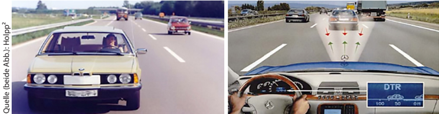
Abb. 5: Frühes Entwicklungsmuster eines 35 GHz Autoradars (links) und Darstellung des Mercedes Benz DISTRONIC Systems von 1999 (rechts)
