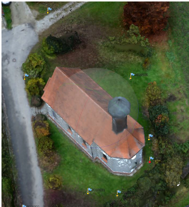
Abb. 27: Orthophoto in Agisoft mit Passpunkten
