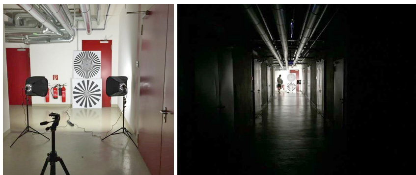
Abb. 4: Testaufbau zur Bestimmung des geometrischen Auflösungspotenzials von UAV-Kamerasystemen (Labortest am DLR Berlin)
