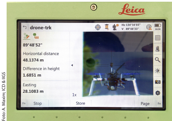
Abb. 8: Mutikopter im Anzeige- bereich eines Tachy- meters
