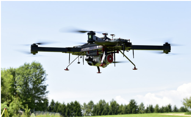
Abb. 1: RiCOPTER mit Sensor Nutzlast VUX-SYS inklusive Doppel-Kamera- system im Flug
