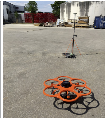
Abb. 6: Lokale GNSS-Referenzstation – UAV mit GNSS-Antenne
