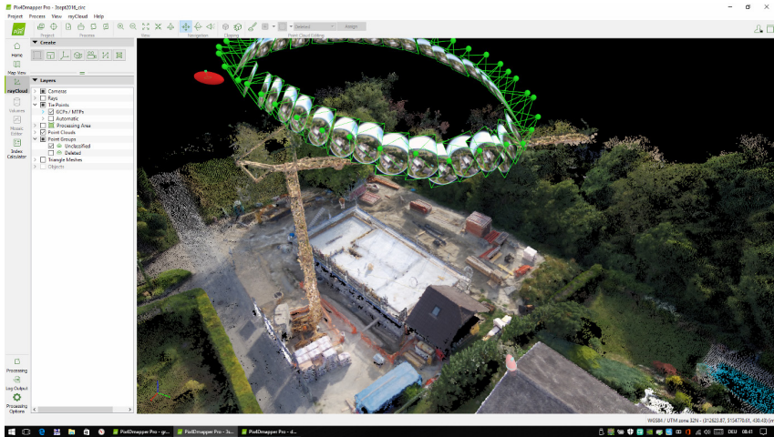
Abb. 5: Rekonstruktion eines elliptischen Flugplans mit der Parrot Bebop2
