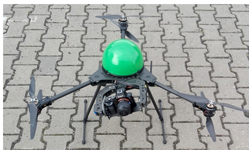
Abb. 1: UAV-Plattform inklusive Sensor Sony α7R
