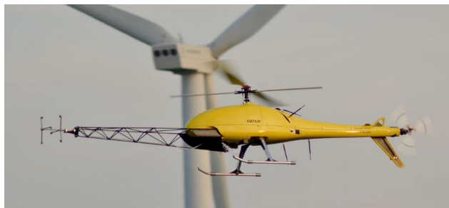
Abb. 3: Helikopter-UAS „Ampair“ des IFB bei der Vermessung des Windfeldes vor einer Windkraft- anlage
