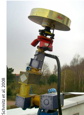
Abb. 6: Nahfeldkalibrierung für die GNSS-Kampagne DHHN 2008
