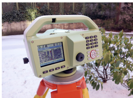
Abb. 1: Modernes Nivellierinstrument neuester Generation mit elektronischer Libelle und kameragestützter Anzielung
