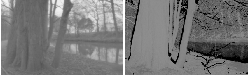
Abb. 4: Projektion der Intensitätswerte der 3D-Punkte in das synthetische Panoramabild (links) und das mit der Kamera aufgenommene Referenzbild (rechts). Die schwarzen Anteile im linken Bild entstehen durch die Unterschiedlichen Blickwinkel der Sensoren.
