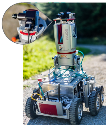
Abb. 1: Aufbau und Sensorik der Roboterplattform Pluto (rechts) sowie eine schematische Übersicht der implementierten Softwarekomponenten und des Ablaufs der Kalibrierung (unten)
