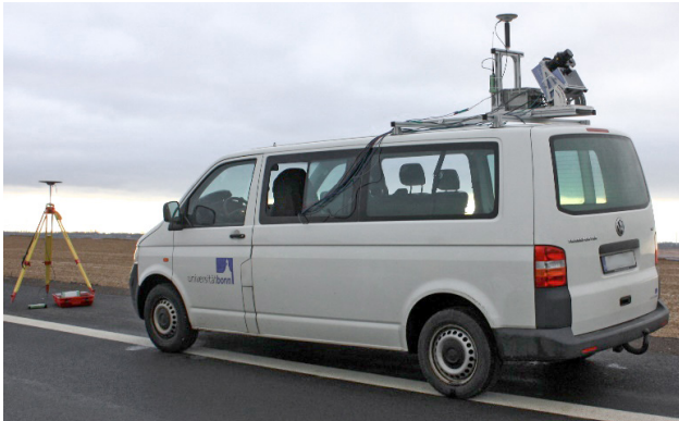
Abb. 4: Fahrzeuggebundenes System mit hochwertiger IMU, Profillaserscanner und GNSS-Empfänger mit eigener Referenzstation
