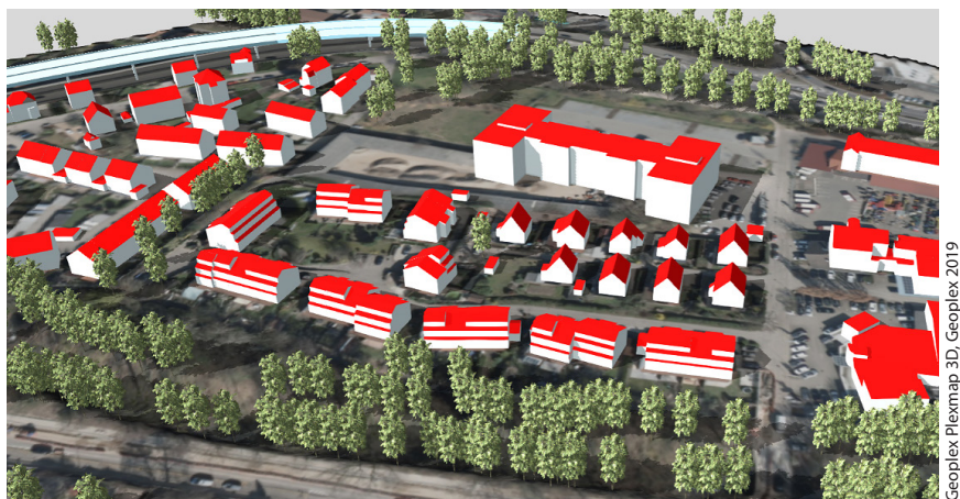
Abb. 5: 3D-Modell mit Bestandsgebäuden, Planung, relevanten Bäumen aus dem Baumkataster, Licht- und Schattenwurf
