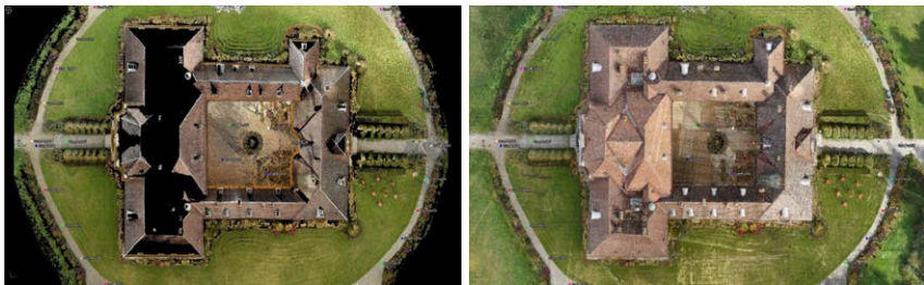
Abb. 4: Orthogonale Ansicht einer eingefärbten Punktwolke von oben. Links: ausschließlich terrestrische Laserscanning-Daten. Rechts: Kombination von TLS und ULS
