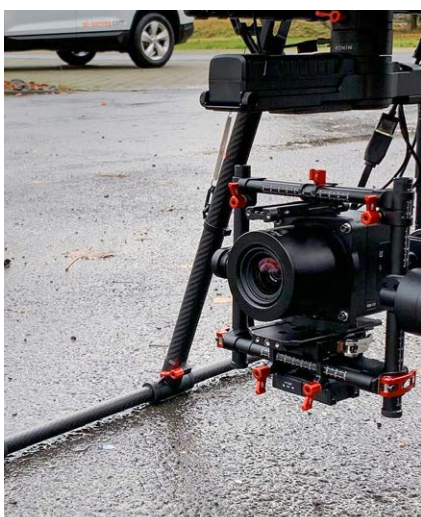
↙ Abb. 3: Kameraaufhängung für die Mittelformat- kamera Phase One iXM 100
