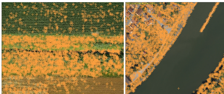
Abb. 1: Automatisch bestimmte Verknüpfungspunkte für unterschiedliche Landnutzungsarten
