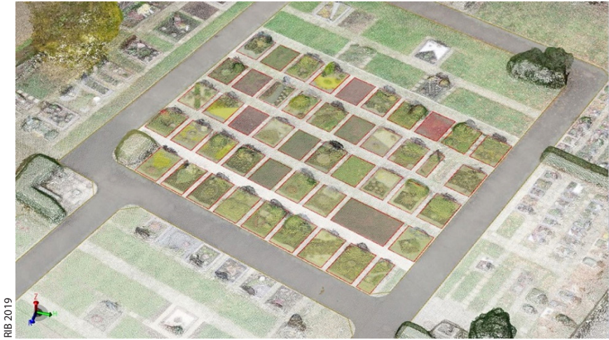
Abb. 23: CAD-Bearbeitung von Grabflächen inkl. Wegenetz aus Punktwolke
