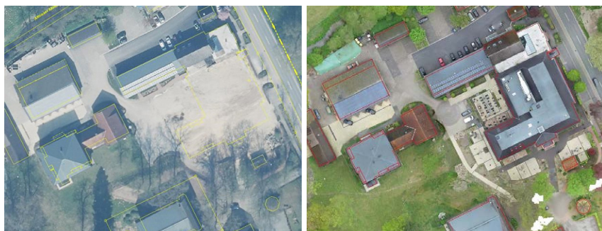
Abb. 7: Links: Orthofoto (20 cm). Rechts: UAV-TrueDOP (1,5 cm)
