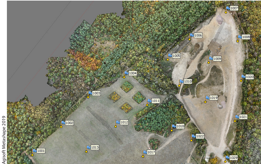
↑ Abb. 6: Punktwolke mit Bodenpass- punkten
