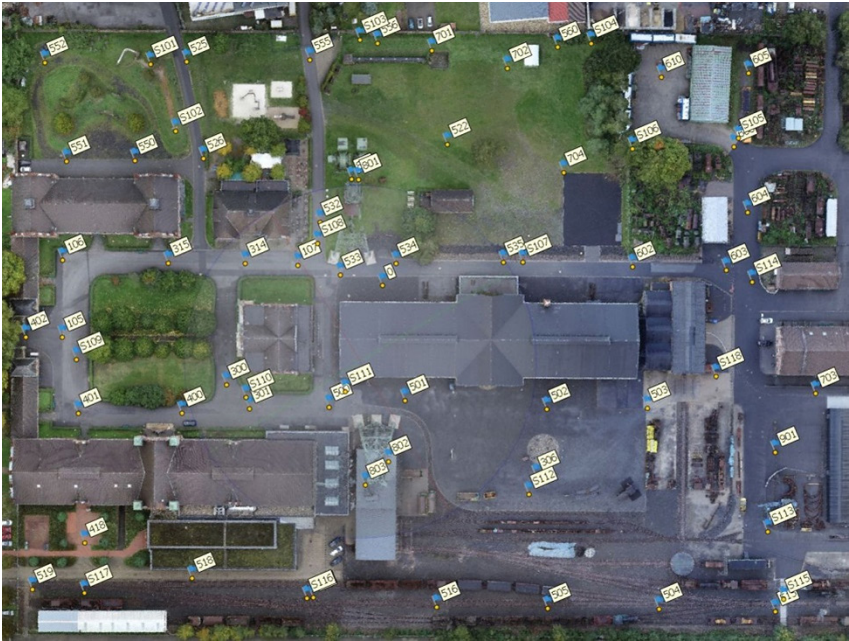
Abb. 4: Tachymeterstandpunkte und Kontroll- und Passpunkte (30.9.2019)
