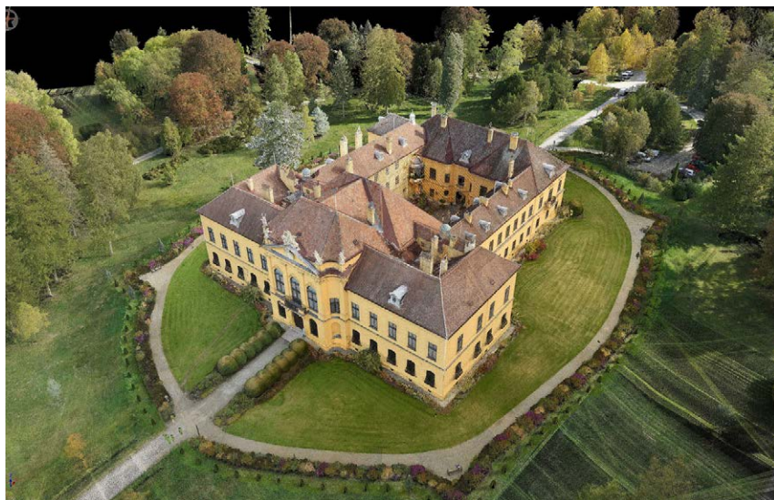
Abb. 3: Einfarbte Punktwolke einer ULS-Befliegung
