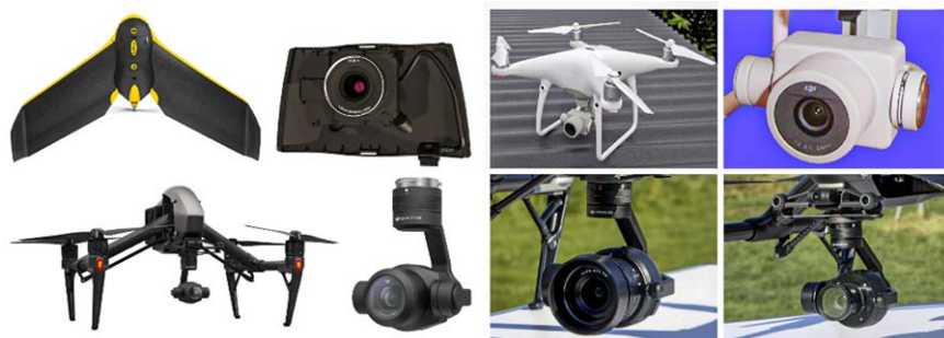
Abb. 2: Untersuchte UAV-Systeme: Oben: senseFly ebee mit S.O.D.A. (links), DJI Phantom 4 Pro mit Zenmuse X4S (rechts). Unten (v. l. n. r.): DJI Inspire 2 mit Zenmuse X4S, mit Zenmuse X5S und mit Zenmuse X5S (modifizierte Optik)
