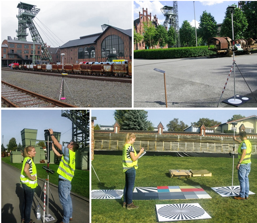
Abb. 1: RTK-GNSS-Messungen mit Trimble R8, Leica GS15, GS16
