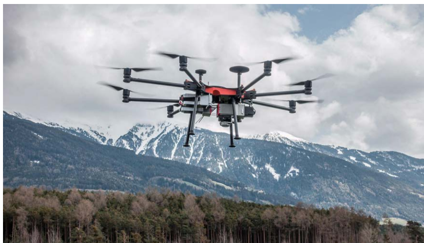
Abb. 12: Oktokopter „Soleon LasCO x8flat“ mit integriertem RIEGL miniVUX-1UAV Laser-scanner
