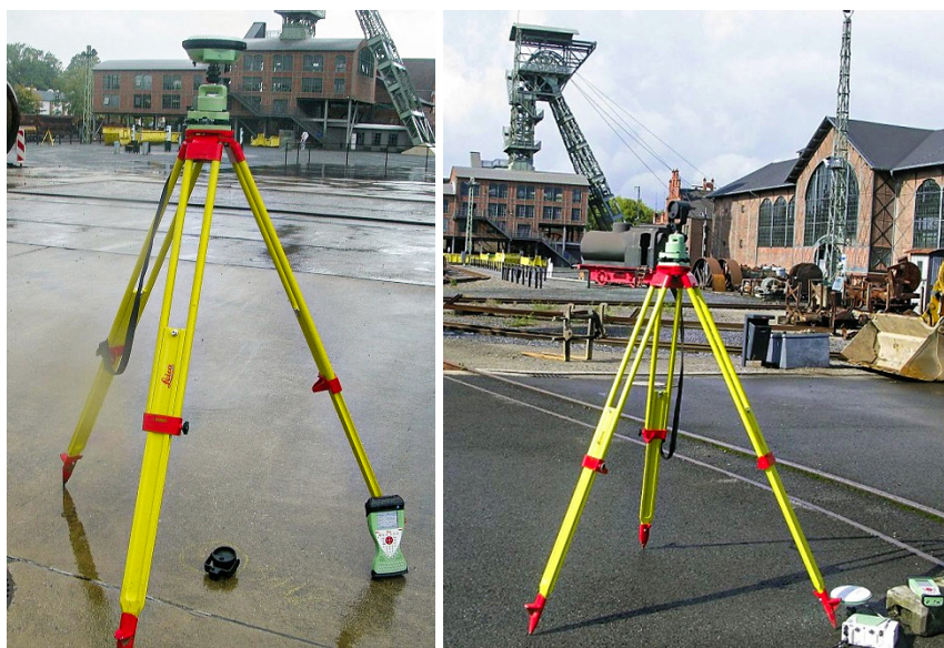
Abb. 6: Statische GNSS-Messungen auf den Standpunkten mit Zwangszentrierung
