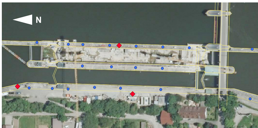
Abb. 2: Testfeld Schleusenanlage Hessigheim. Alle Punkte sind mit luft sichtbaren Schachbrettafeln signalisiert. Die drei gesondert in rot gekennzeichneten Punkte sind zudem Messpfeiler des Bauwerksnetzes.
