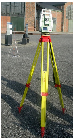
← Abb. 2: Netzmes- sungen mit Leica TS15
