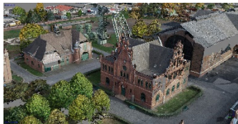
Abb. 7: Vollständigkeit der dichten Punktwolke für Objekte mit vertikaler Ausdehnung (Fassaden) bei variierender Aufnahmerichtung (Nadir/Oblique)
