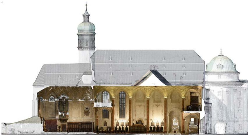
Abb. 6: Kombination eines terrestrischen Laserscans mit einer SfM-Punktwolke aus einer UAV-Befliegung, Hofkirche Innsbruck
