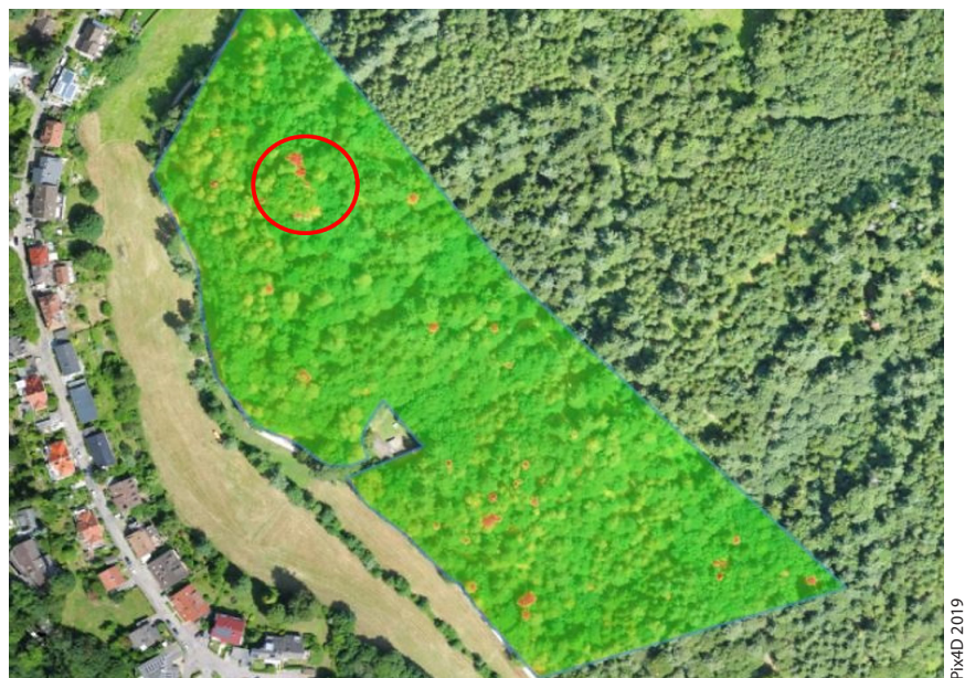
Abb. 18: Indexkarte mit hinterlegtem Orthophoto (Pix4D Mapper)
