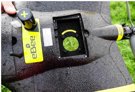
Abb. 16: Kameraschacht der eBee Plus (links) und S.O.D.A. RGB-Kamera der senseFly (rechts)
