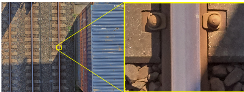
Abb. 6: Volle Abdeckung eines Luftbilds aus 35 m Höhe ( 11.664 \times 8.750 ) und Bildausschnitt ( 507 \times 380 Pixel, entspricht ca. 45 \times 34 cm)
