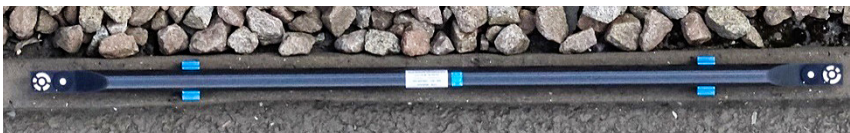
Abb. 9: Hochgenau kalibrierter CFK-Maßstab zur Überprüfung des lokalen Bildmaßstabs
