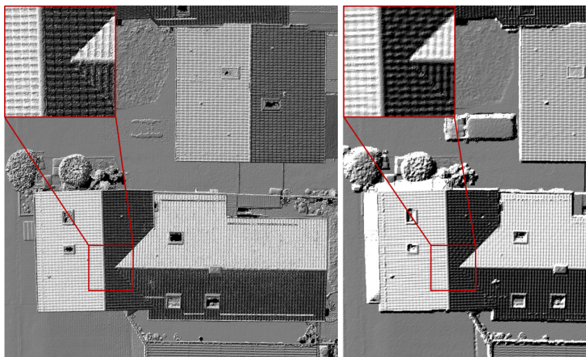
Abb. 6: Schummerung des DOM aus MVS mit Rasterweite 5 mm (links) und LiDAR mit Rasterweite 2,5 cm (rechts)
