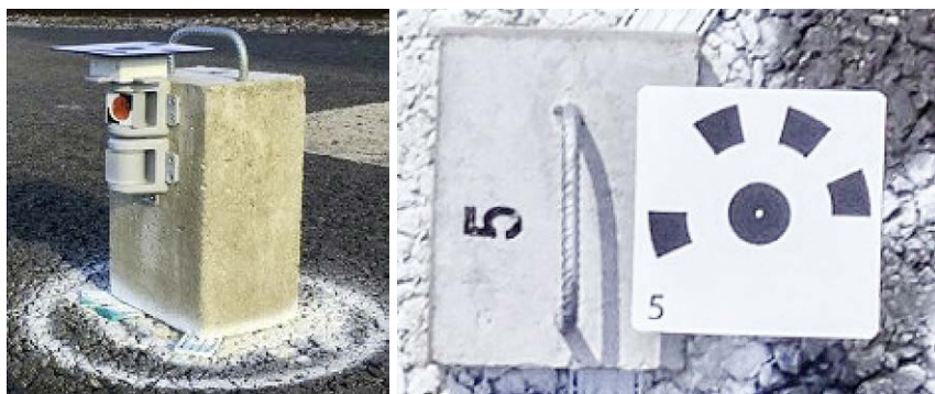
Abb. 2: Der Aufbau der Zielmarke mit den Prismen: die Zentren der drei Elemente sind kollinear angeordnet, die Abstände sind bekannt (links); Marke im Luftbild (rechts).
