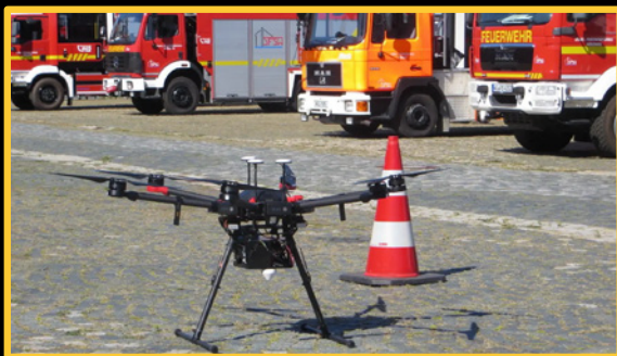
UAV mit Velodyne Lidar, Optris® Thermocam und RGB camera, IMU, GNSS (video)
