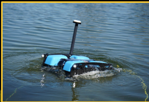
BlueRov Roboter (kabelgebunden) mit Kameras, IMU und GPS
