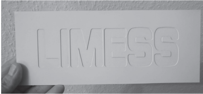
Messobjekt: Aluminiumplatte mit 0,5mm tiefer Gravur, weiß lackiert
