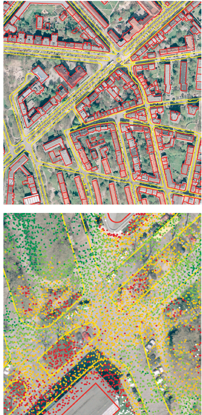
Abb. 1: Ausschnitte aus dem Testgebiet Hamburg-Altona. Obere Abbildung (Größe ca. 400 m × 400 m): Das unterliegende Orthofoto interpretiert die für die Modellgenerierung verarbeitete polygonale Information für Gebäudebegrenzungen (rot) und Bordsteine (gelb). Untere Abbildung (Größe ca. 80 m × 80 m): Laserscannerpunkte mit Höheninformation. (Luftbildaufnahme mit Zustimmung der LGV Hamburg.)
