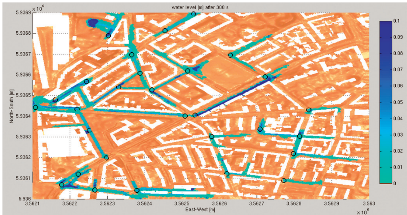
Abb. 12: Berechnete Wasserstände (blaue Farbcodierung, braune Farbe: Wasserstand kleiner als 0,001 m) auf der Oberfläche des Modells von Abb. 8 zu überstauenden Schächten (schwarze Kreise). Beachte: Sowohl das durch die Schächte repräsentierte Kanalmodell als auch das Szenario des gleichzeitigen Überstaus sind rein fiktiv und nur zu Demonstrationszwecken so gewählt.
