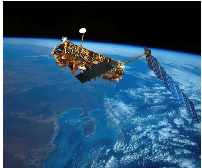
Abb. 6: Der europäische Umweltsatellit ENVISAT mit dem für die Beobachtung der Meeresalgen relevanten Sensoren MERIS und SCIAMACHY. Envisat befindet sich seit März 2008 im All und bildet die Plattform für insgesamt 10 Sensoren, deren wichtigste Aufgaben die ständige Beobachtung des Klimas, des Ozeans, und der Landfläche der Erde ist. (Quelle: ESA)
