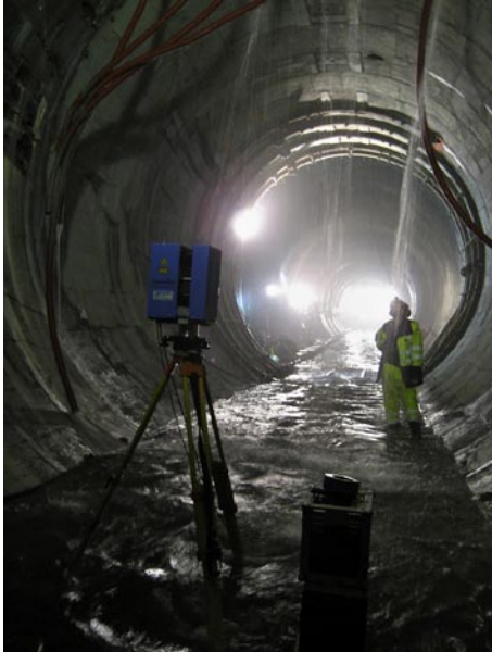
Abb. 11: Z + F Imager 5003 im Einsatz im Headrace- Tunnel
