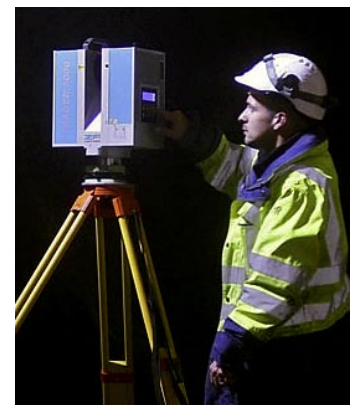
Abb. 18: Z + F Imager 5006 im Headrace-Tunnel
