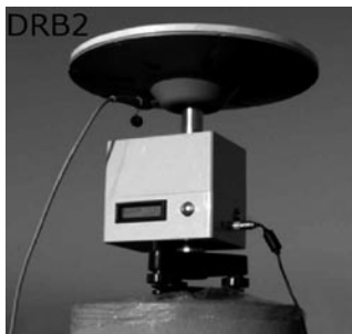
Abb. 3: Beschleunigung der Feldkalibrierung durch die Dreheinrichtung DRB2 an der TU Dresden (Frevert et al. 2006)
