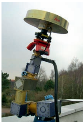
Abb. 17: Kalibrierung einer Antenne zusammen mit ihrem Unterbau für die GNSS-Kampagne DHHN 2008 (Schmitz et al. 2008b)
