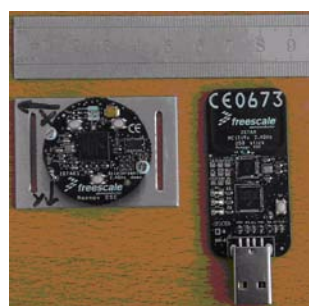
Abb. 11: Sensorplatine und USB-Dongle
