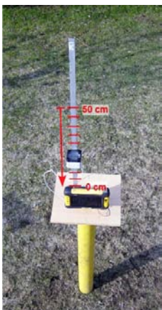
Abb. 7: Feldversuch: AR-System auf nichtmagnetischem Messpfiler
