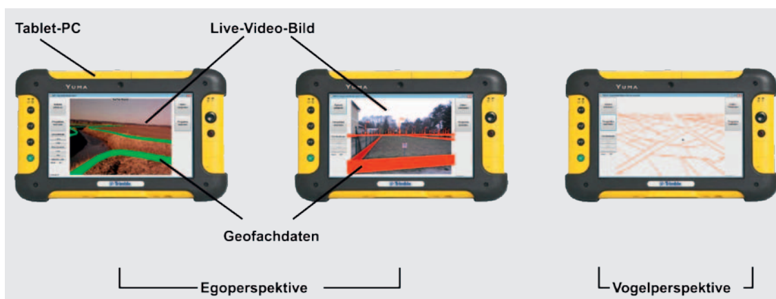
Abb. 1: Überlagerung von Geofachdaten mit einem Live-Video-Bild (links, mitte), Datensicht aus exponierter Lage (rechts)
