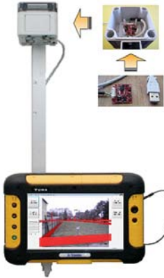
Abb. 10: Augmented-Reality-System für die Planung und Boden- ordnung
