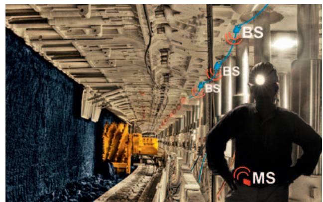
Abb. 1: Systeminfrastruktur für lokale Personendetektierung im Untertagebau zur Kohlegewinnung (BS – Basisstation, MS – Mobile Station)
