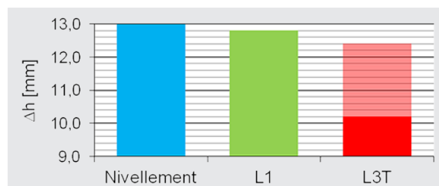
Abb. 12: Topozentrische Höhen von MSD5 relativ zu MSD8 aus unterschiedlichen Mess- und Auswerteverfahren. Die berechnete Höhenkorrektur für L3T von 2,2 mm ist rot transparent dargestellt.
