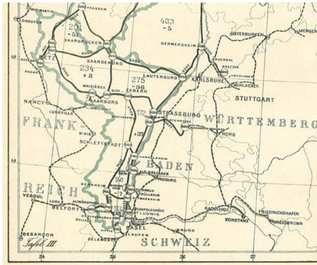
Abb. 4: Südwestlicher Ausschnitt des preußischen Nivellementnetzes, aus Tafel III in Preußen (1894)
