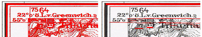
Abb. 2: Ausschnitt Rahmenbereich vor und nach Hough-Transformation und morphologischen Operatoren
