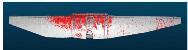
Abb. 23: Signifikante Abweichungen (rot) beim M3C2-Vergleich der Brucher-Talsperre (CloudCompare)
