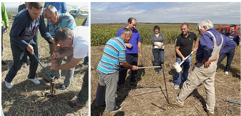
Abb. 4: Entnahme von Bodenproben in der Flurbereinigung Žitarađa mit Bohrstock und Hebegerät
