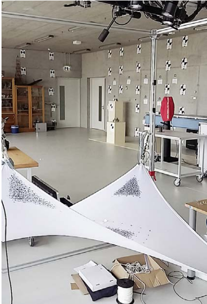
Abb. 2: Prototyp des Fassadenelements zur Bestimmung von Dehnungen mit FBG-Sensoren und ARAMIS
