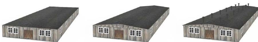
Abb. 2: Gebäude im LOD1, LOD2 und LOD3 (von links)
