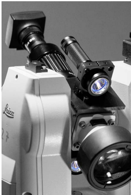
Abb. 2: Prototyp des Digitalkamera-theodolits inkl. zwei ex-zentrischen LED-Leuchten, Okularadapter und C-Mount Industriekamera. Nicht dargestellt sind die Zugentlastung des USB-Kabels und die Gegengewichte zur Kamera.
