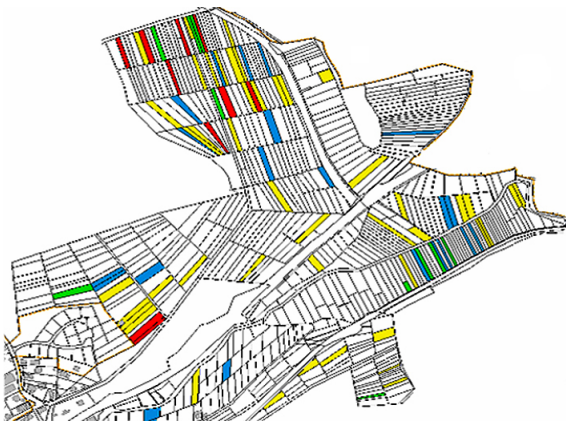
Abb. 6: Ausschnitt aus dem alten Bestand (links) mit insgesamt 3.200 Flurstücken und dem neuen Bestand (rechts) mit insgesamt 1.245 Flurstücken der Flurbereinigung Herborn-Uckersdorf (Lahn-Dill-Kreis) sowie Hervorhebung der Arrondierung der Grundstücke von vier Teilnehmern
