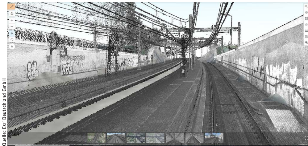
Abb. 4: Punktwolkendarstellung von LiDAR-Daten der Schieneninfrastruktur in Amsterdam
