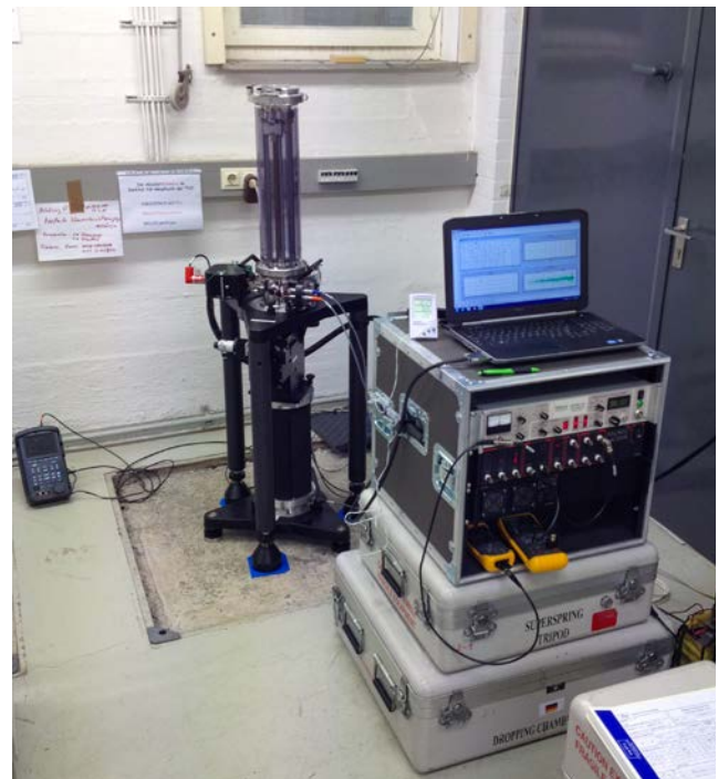
Abb. 2: Absolutgravimeter FG5X-220 des Instituts für Erdmessung bei einer Messung an der TU Clausthal, Institut für Geophysik
