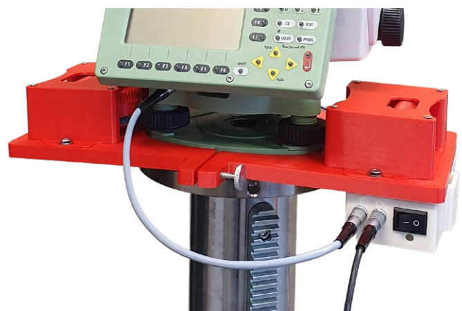
Abb. 5: Adapter-Prototyp mittels 3D-Druck zur Horizontierung eines Leica Tachymeters
