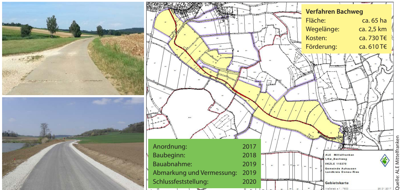
Abb. 5: Umsetzung ländlicher Kernwegenetzkonzepte am Beispiel des Verfahrens Bachweg, Landkreis Donau-Ries. Links: Zustand des Weges vor und nach dem Ausbau als Hauptwirtschaftsweg. Rechts: Verfahrensdaten und neu geordnete Grundstücke zur Ermöglichung der Wegeverbreiterung und Lösung des daraus entstandenen Landnutzungskonfliktes
