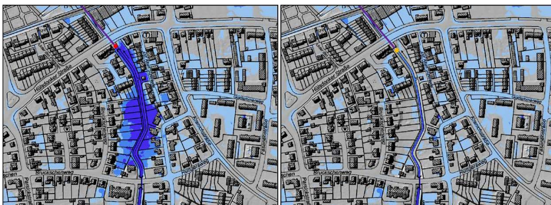
Abb. 2: Ergebnis nach der ersten Simulation (links) und nach der Vorortkontrolle (rechts)
