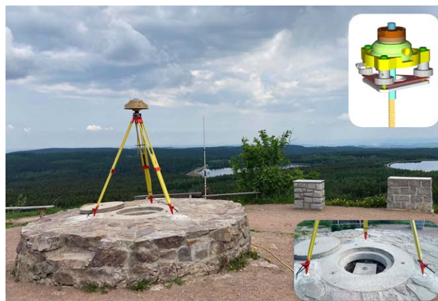
Abb. 2: Messaufbau am GGP Kahleberg (SN). Die GNSS-Antenne wurde mit einem Stativ zentrisch über der Punktmarke (s. Detailbild unten rechts) aufgebaut. Für die zuverlässige Bestimmung der Antennenhöhe mittels Präzisionsnivellement wurde die Spezialmesseinrichtung FG-ANA-100B verwendet (s. Detailbild oben rechts).
