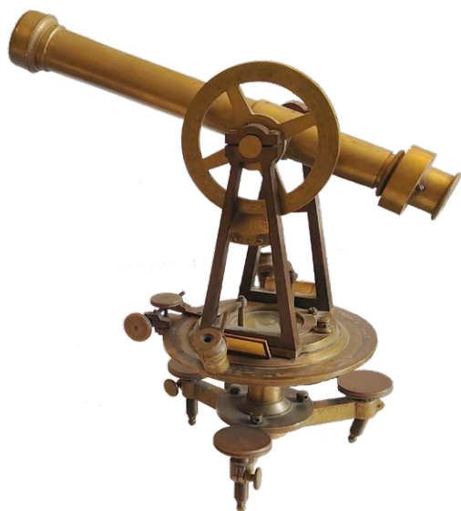
Abb. 6: Kataster-Theodolit Nr. 137 von F.W. Breithaupt & Sohn in Cassel, 1836
